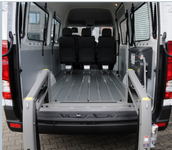
Durch den Smartfloor Aluminium-Systemboden ist die flexible Beförderung von Personen mit und ohne Rollstuhl kein Problem.
