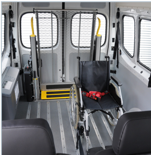
Über den Lift gelangt der Rollstuhl in das Fahrzeug; das AMF-Bruns PROTEKTOR System sichert Person und Rollstuhl.
